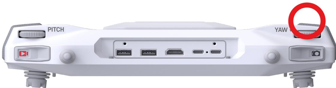
Der rechte Drehregler steuert die Gimbal-Gierachse. Wenn Sie den Drehregler nach rechts drehen, dreht sich der Gimbal nach rechts. Wenn Sie den Drehregler nach links drehen, dreht sich der Gimbal nach links. Wenn der Drehregler in einer festen Position ist, behält die Kamera ihre aktuelle Position bei.
