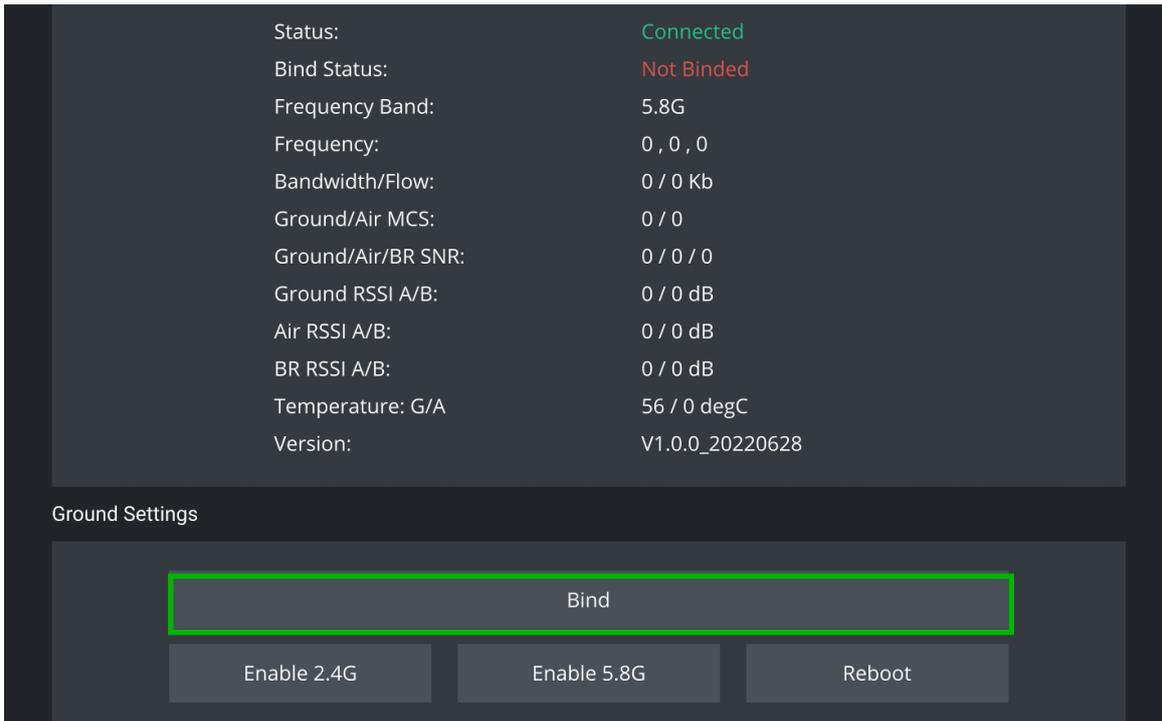
4. Wenn die Verbindung hergestellt ist, leuchtet die Anzeige des transmissions module indikator auf und erlischt dann. Der Controller empfängt Daten vom Fluggerät. Der Bindungsstatus wird grün als „Binded“ angezeigt.
